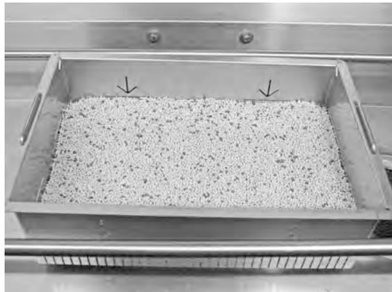
**Abbildung 21 Granulatstand kontrollieren**
