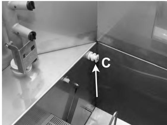
**Abbildung 26 Füllstandsensor**
