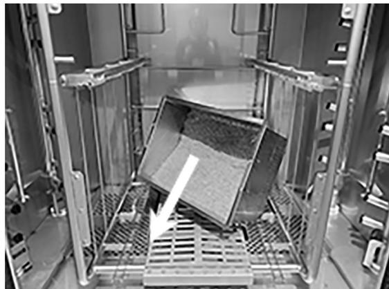
**Abbildung 3 Beschickung mit Granulat**
