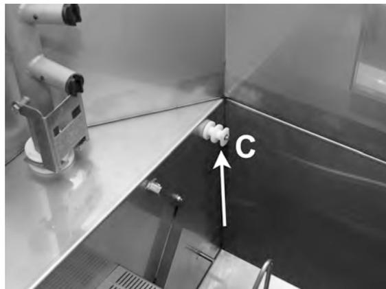
**Abbildung 30 Füllstandsensoren**
