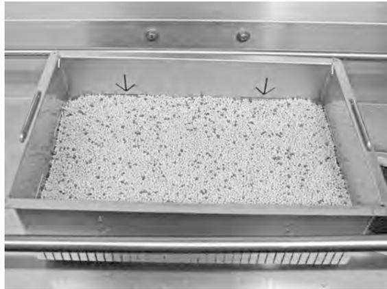
**Abbildung 25 Granulatstand kontrollieren**
