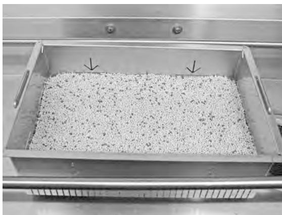
Fig. 25 A granulátumszint ellenőrzése
