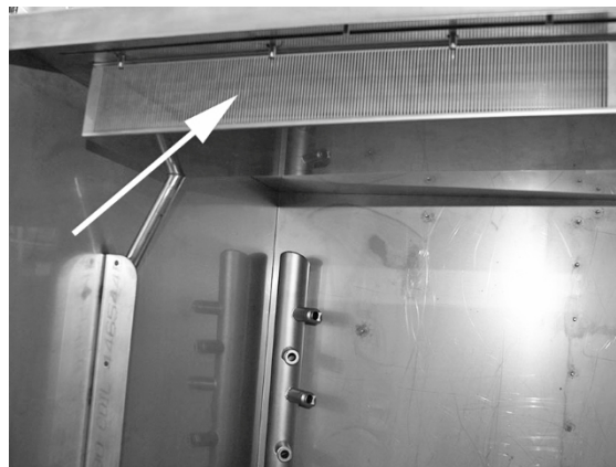
Fig. 38 EcoExchanger vu depuis l'intérieur de la cabine de la machine
