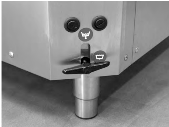
Abbildung 22 Zugang zum Überhitzungsschutz
