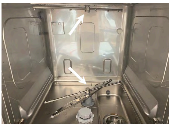
Photo 24 Bras de lavage et de rinçage inférieur et supérieur
