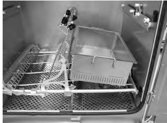
**Abbildung 21 Granulat-Sammelbehälter in der Maschine**
