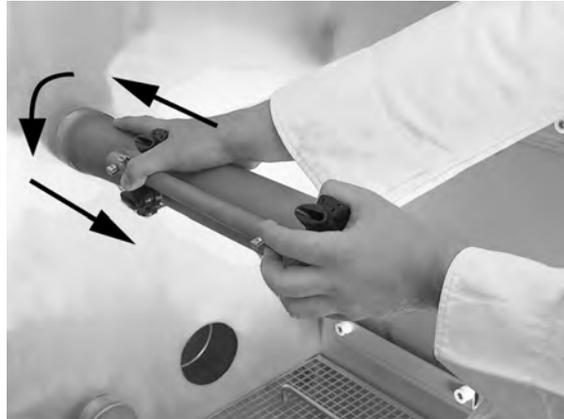
**Abbildung 23 Abnahme der Sprührohre**
