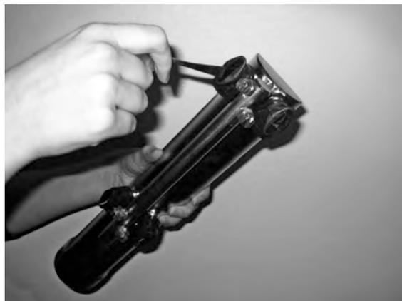
**Abbildung 24 Reinigung der Spüldüsen**
