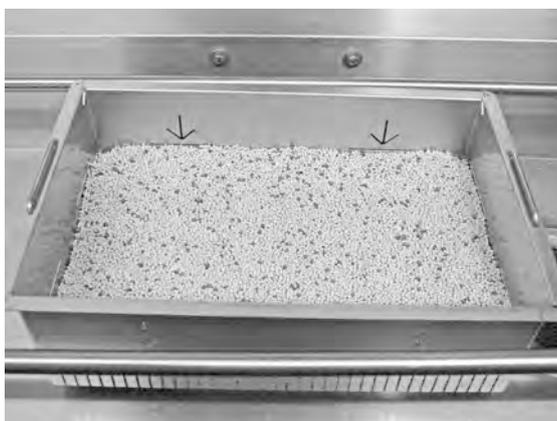
**Abbildung 22 Granulatstand kontrollieren**
