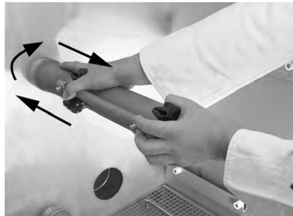
**Abbildung 30 Einbau des Sprührohrs**
