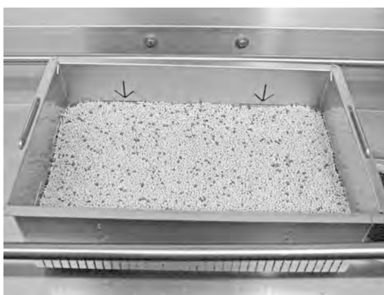
Obrázek 22 Kontrola hladiny granulí
