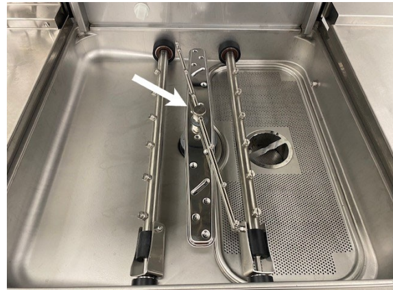
Abbildung 24 Untere Sprüh- und Spülarme entfernen
