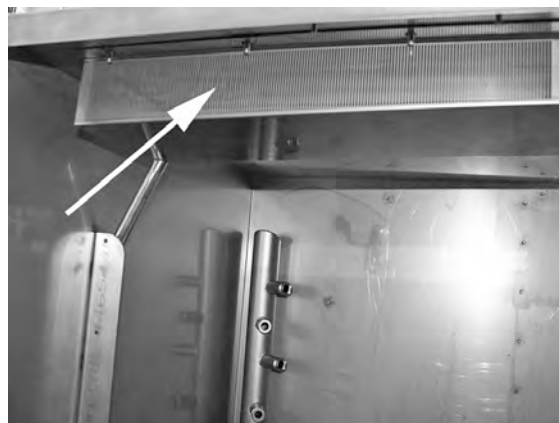
Figure 45 EcoExchanger , гледан от вътрешната страна на корпуса на машината
