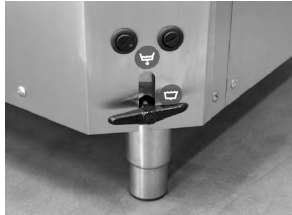
Abbildung 20 Zugang zum Überhitzungsschutz
