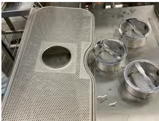
Obrázek 26 Očištění filtrů a mřížky nádrže
