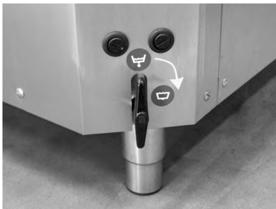
Photo 6 Vanne de remplissage
