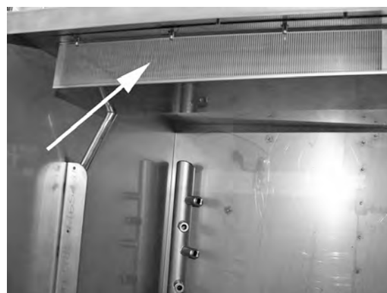
Imagine 45 EcoExchanger după cum este văzut în interiorul mașinii
