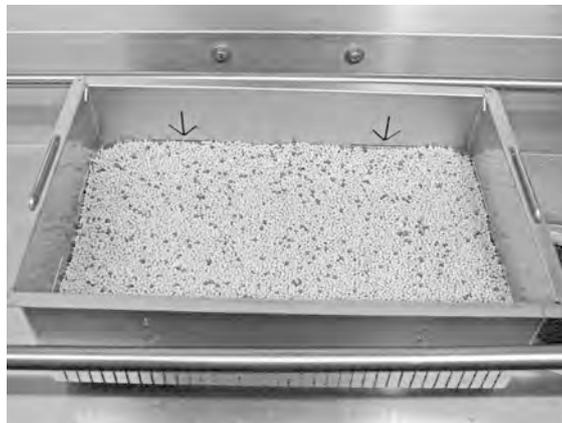
**Figura 21 Controllare il livello dei Granuli**
