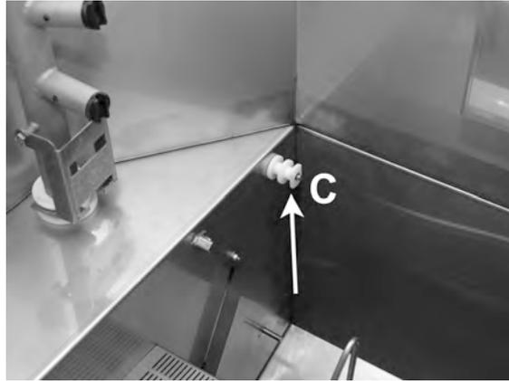
**Figura 26 Sensore di livello**
