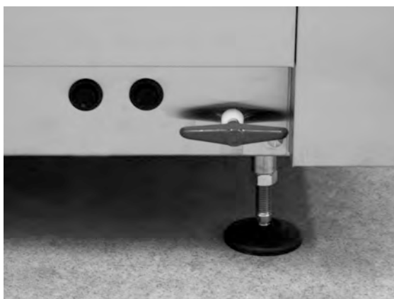
Fig. 24 Hozzáférés a túlmelegedés-védőkhöz
