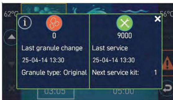
*Fig. 35 Informations sur le dernier changement de granules et le service*
