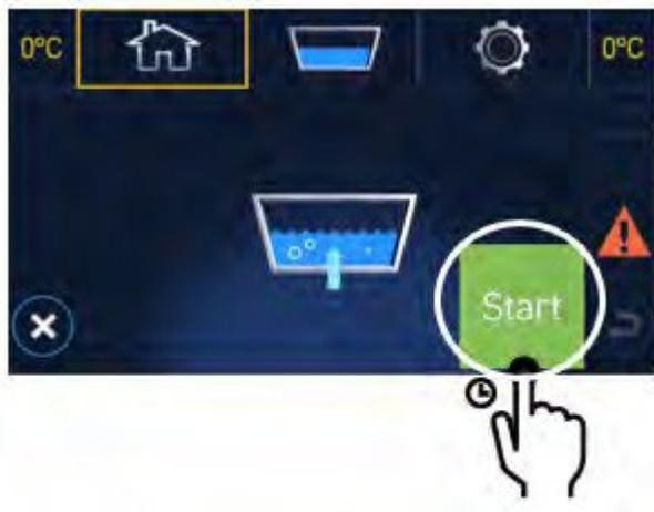
La machine commence à remplir les réservoirs d'eau qui chauffe jusqu'à ce que la température de lavage correcte soit atteinte.
