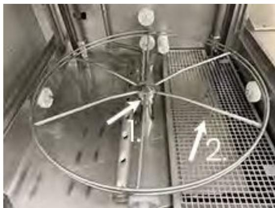
Fig. 28 *Roue du panier et grille du réservoir*
