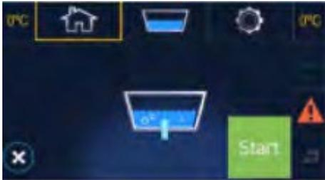
**MENU DÉMARRER** — avec possibilité de démarrer le remplissage et le chauffage, d'ouvrir le menu du réservoir ou le menu des paramètres.
