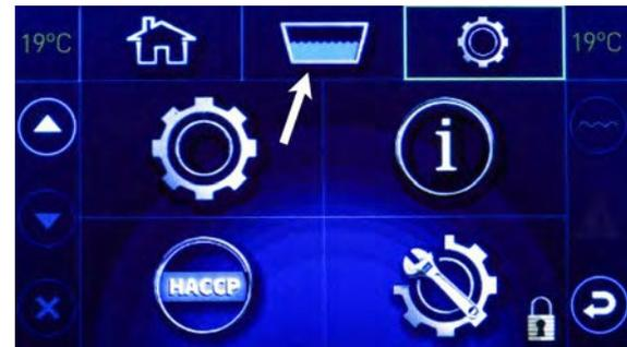
Fig. 4 *Machine de changement d'eau/vidange*
