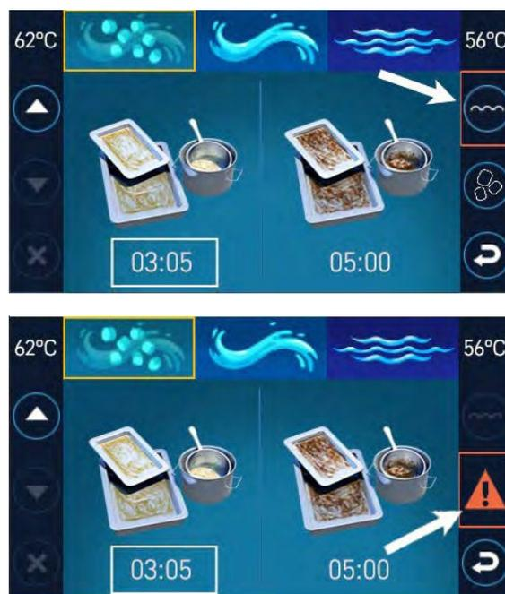
Fig. 34 Alerte d'entretien et de changement des granulés
