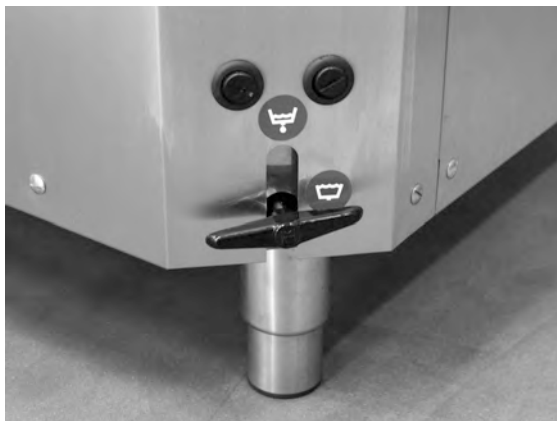
obraz 22 Dostęp do zabezpieczeń przed przegrzaniem
