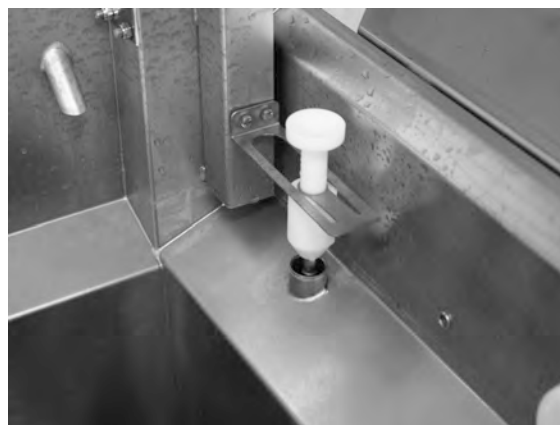
obraz 30 Kran przelewowy
