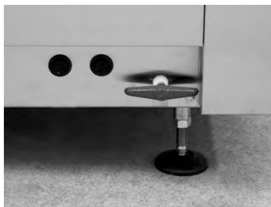
obraz 28 Dostęp do zabezpieczeń przed przegrzaniem
