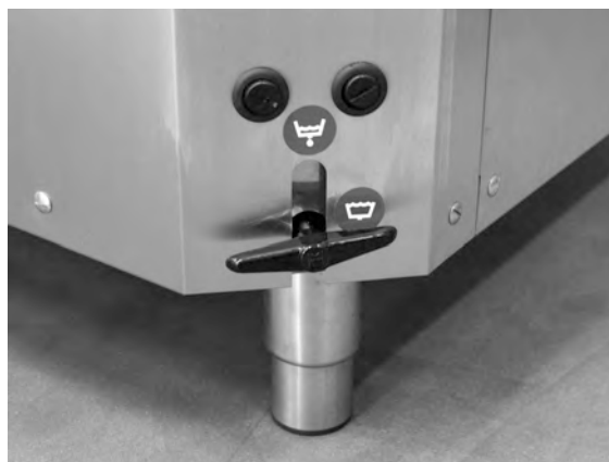
Bild 20 Åtkomst till överhettningsskydden
