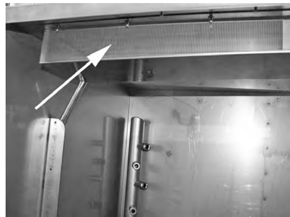
Photo 45 EcoExchanger vu de l'intérieur de la cuve
