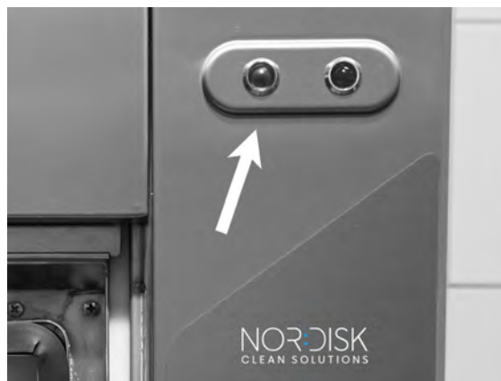
Photo 25 Lorsque le programme est terminé, le témoin vert s'allume.
