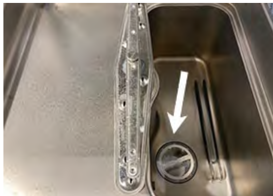
Abbildung 18 Ausbau des Filters
