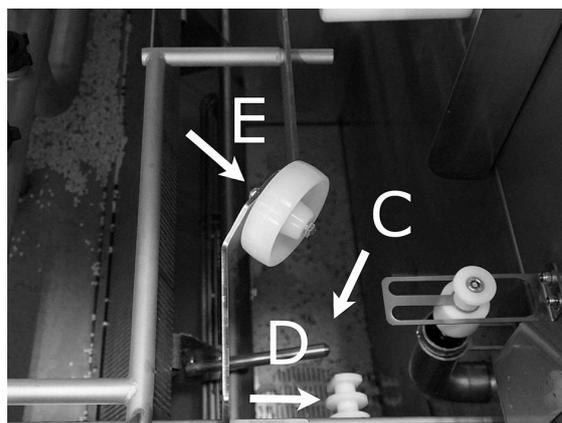
**Figura 42 Filtro a rete di fondo e sensore di livello**
