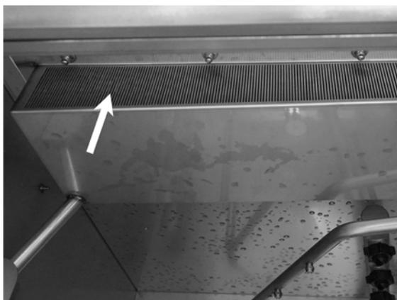
**Figura 48** *EcoExchanger visto dall'interno della cabina della macchina*
