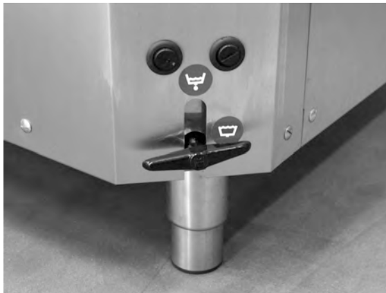
Bild 22 Åtkomst till överhettningsskydden
