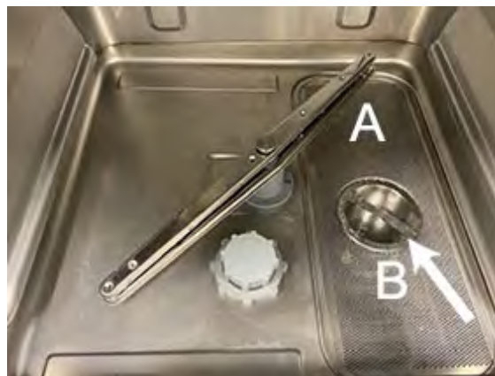
Figure 14 Отстраняване на решетката на резервоара и филтъра
