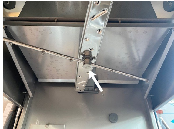
Fig. 20 Bras de lavage et de rinçage supérieurs
