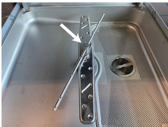
Fig. 19 Bras de lavage et de rinçage inférieurs
