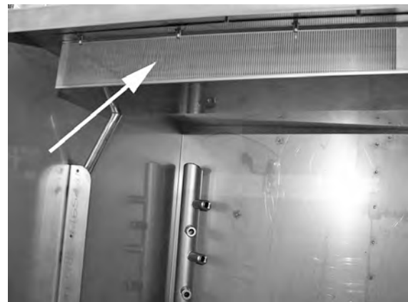
Abbildung 41 EcoExchanger in der Maschine
