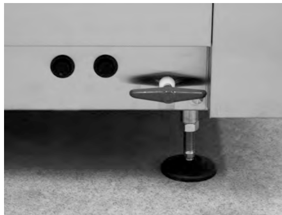
Abbildung 22 Zugang zum Überhitzungsschutz
