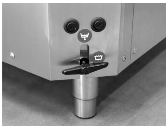
Fig. 25 Hozzáférés a túlmelegedés-védőkhöz
