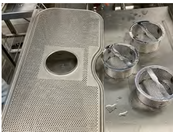
Bilde 26 Rengjøre filterne og tankristen
