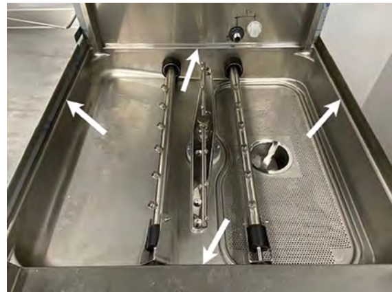
Bilde 27 Tørke av kantene av tanken
