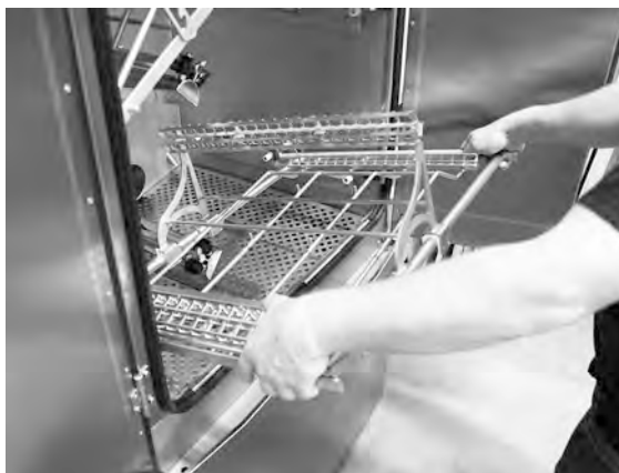
Figure 6 Наклонете подложката нагоре
