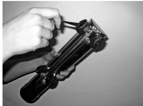
Figure 24 Почистване на дюзите за измиване
