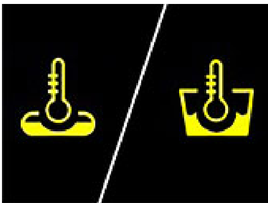
Afbeelding 10 Thermostop was- of spoeltank
