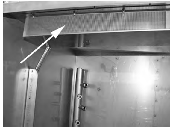
Fig. 34 A képen az EcoExchanger látható a gép mosogatóterében.
