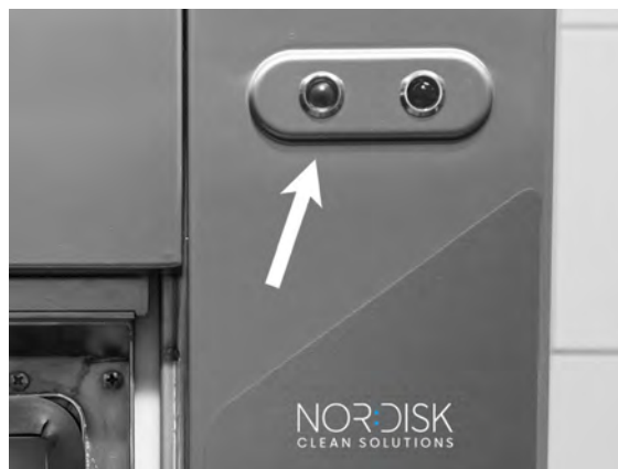
Abbildung 27 Wenn das Programm beendet ist, leuchtet die grüne Lampe auf.
