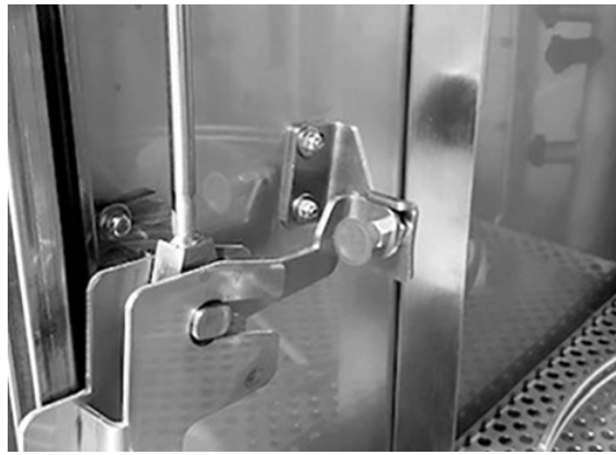
Abbildung 32 Nahaufnahme: Arm korrekt sichern
