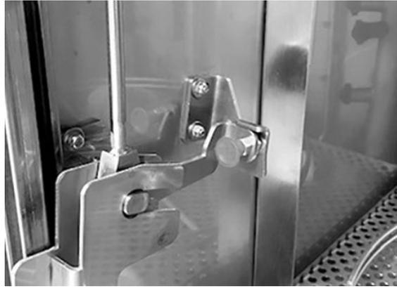
**Imagen 28 Vista de cerca: fijar el brazo correctamente**
