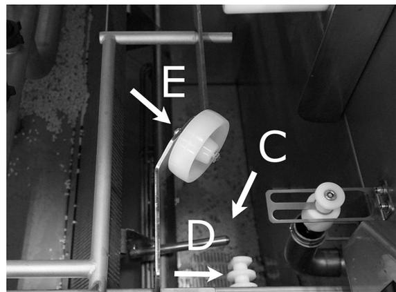
**Imagen 38 Filtro del fondo, sensor de nivel y rodillos**
