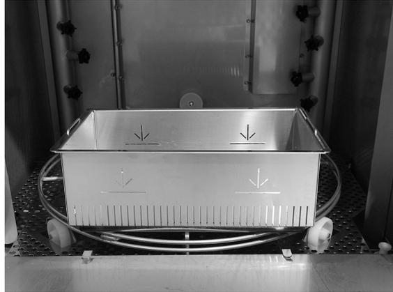
**Imagen 32 Colector de gránulos en la máquina**
