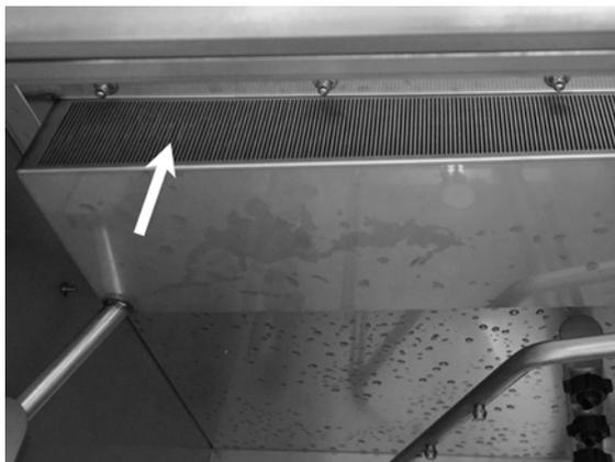
**Imagen 44 EcoExchanger visto en el interior de la cabina de la máquina**
