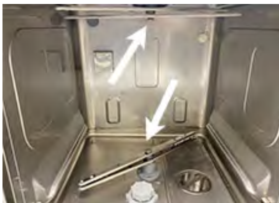
obraz 18 Dolne i górne ramiona natrysznicy myjącej i płuczacej
