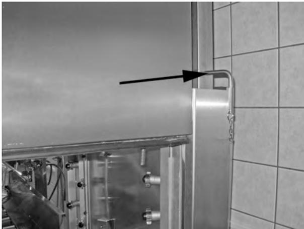
изображение 33 Фиксатор крышки
