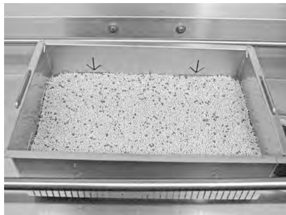
Obrázek 35 Kontrola hladiny granulí
