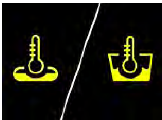
Imagen 9 Parada térmica de las cubas de lavado o de aclarado
