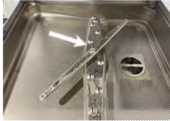
Imagen 19 Brazos de lavado y aclarado inferiores
