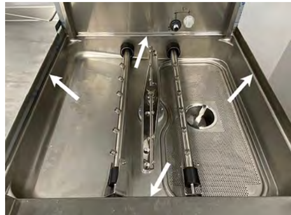
Fig. 29 A tartály széleinek letörlése
