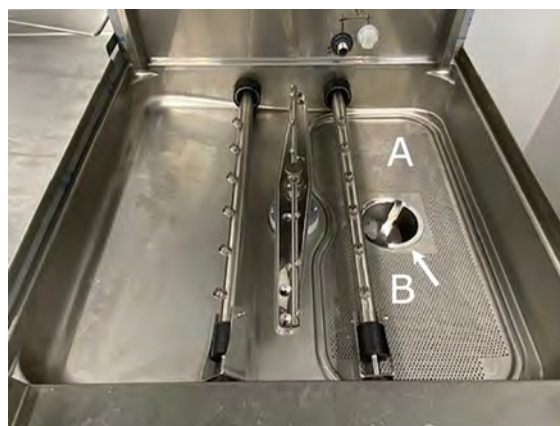
Fig. 24 A tartályrács és a szűrő eltávolítása
