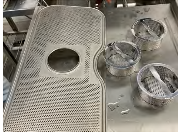
Fig. 28 A szűrők és a tartályrács tisztítása
