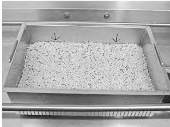
**Abbildung 28 Granulatstand kontrollieren.**
