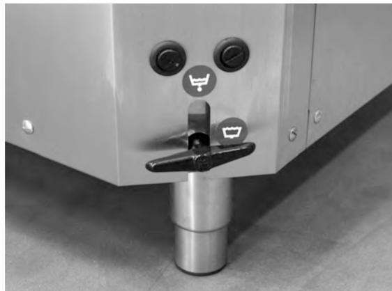
**Abbildung 25 Zugang zum Überhitzungsschutz**
