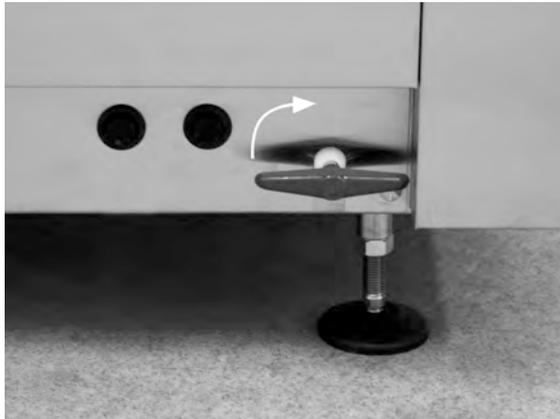
**Fig. 32** *Open drain valve*
