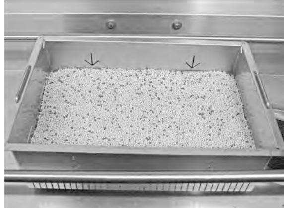
**Fig. 31 Check Granule level**
