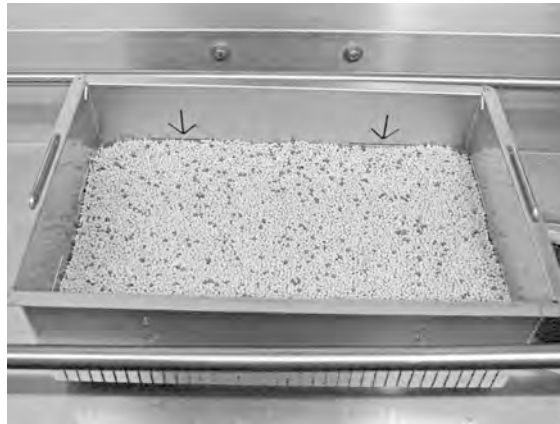
Obrázek 23 Kontrola hladiny granulí
