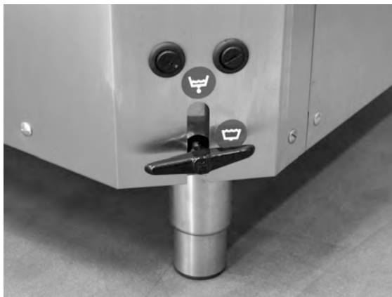
Obrázek 20 Přístup k ochraně proti přehřátí
