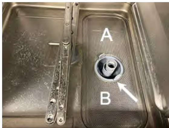
Bilde 11 Fjerne tankristen og filteret
