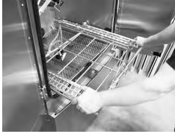
Abbildung 5 Den Einsatz herausziehen.
