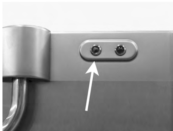
Abbildung 18 Wenn das Programm beendet ist, leuchtet die grüne Lampe auf.
