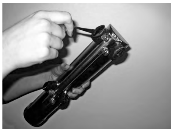
Abbildung 24 Reinigung der Spüldüsen
