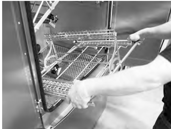
Abbildung 6 Den Einsatz nach oben kippen.
