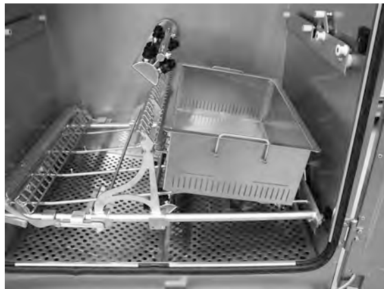
Abbildung 21 Granulat-Sammelbehälter in der Maschine
