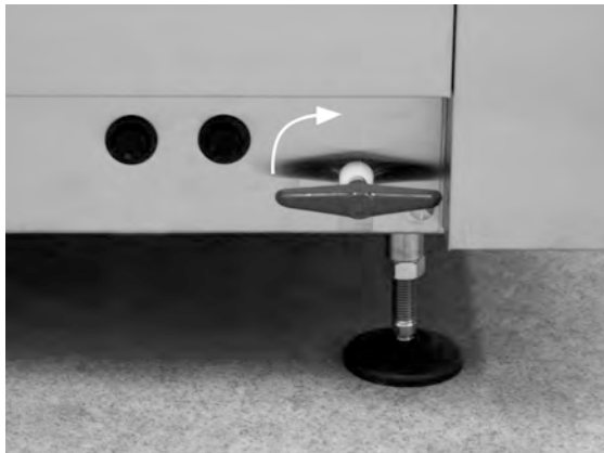
Fig. 32 Nyissa ki a leeresztőszelepet
