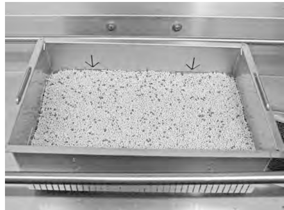
εικόνα 31 Έλεγχος της στάθμης των Granule
