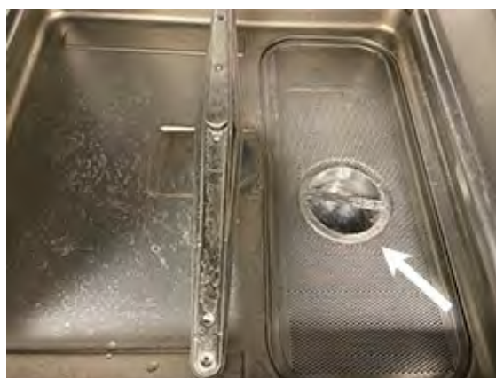
Billede 12 Filter med tilvalg af afløbspumpe
