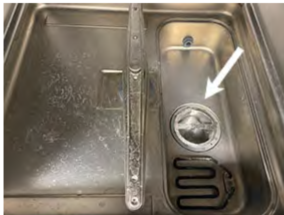
Billede 14 Filter med tilvalg af afløbspumpe
