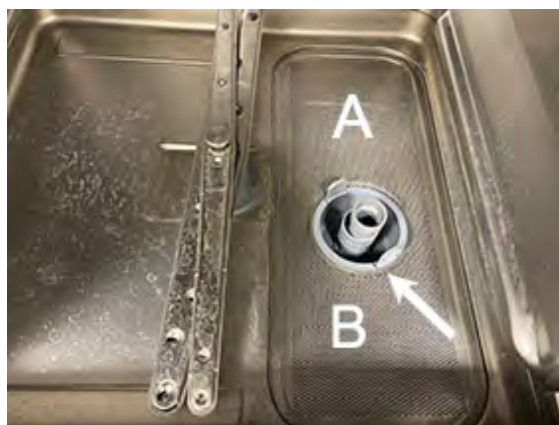
Billede 11 Fjern tankrist og filter
