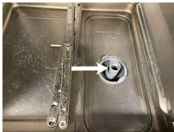
Obrázek 10 Vyjměte přepadovou trubku
