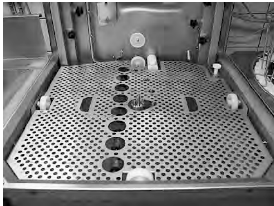
Photo 3 Grille du réservoir
