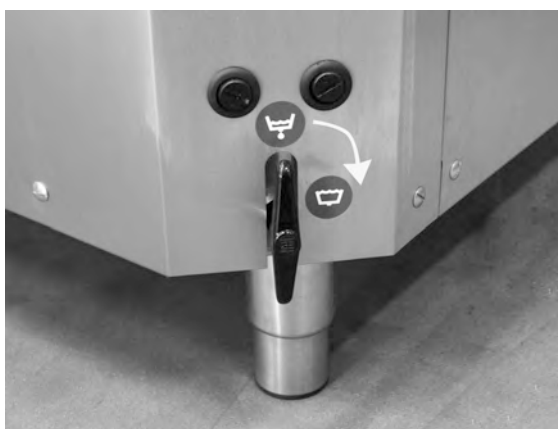
Photo 6 Vanne de remplissage
