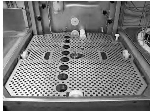
Photo 27 Grille du réservoir
