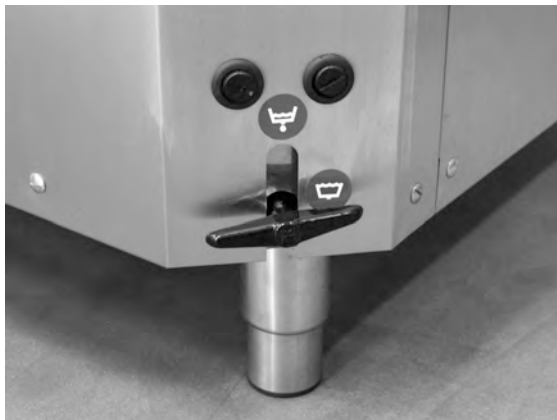
Photo 22 Accès à la protection anti-surchauffe
