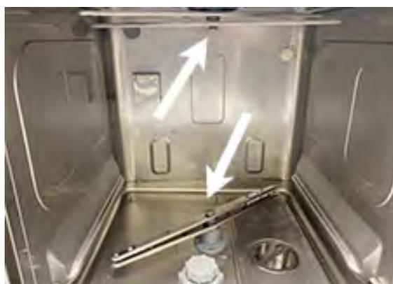
**Abbildung 18** Unterer und oberer Wasch- und Spülarm
