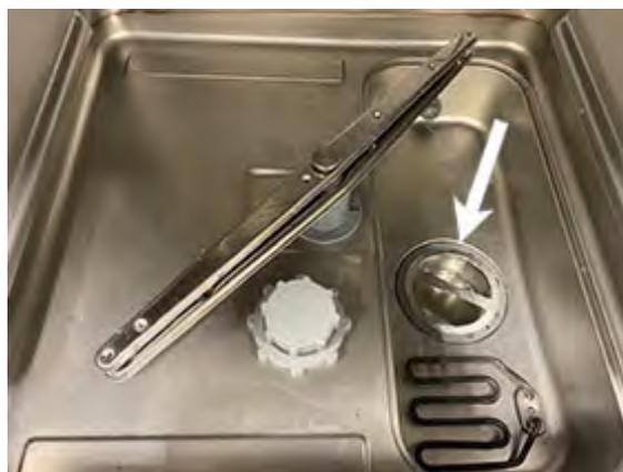
**Abbildung 17** Ausbau des Filters
